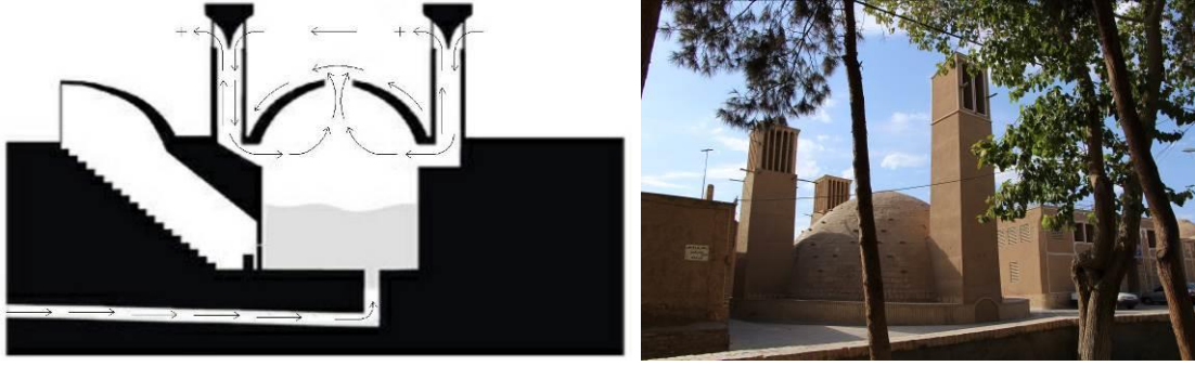
Şekil 9. Ab Anbar olarak adlandırılan su deposu ve havalandırma sistemi (El-Shorbagy, 2010), (Mustafa KAVRAZ Arşivi)
