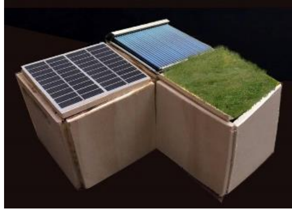
Şekil 14b. Çatı panelleri yerleştirilmiş 1/50 ölçekli üç modüllük temel konut tipi
