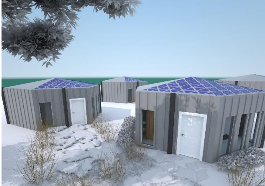
Resim 1. Afet Konutu Görünüşleri ve Çatıya Yerleştirilen Polikristal Fotovoltaik Paneller
